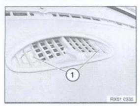
Abdeckkappen (1) im Lüftungsgitter ausheben und darunter liegende Schrauben lösen.
