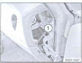
Schrauben (1) links und rechts lösen.
