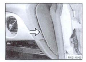
Abdeckung links und rechts in Pfeilrichtung ausheben.
