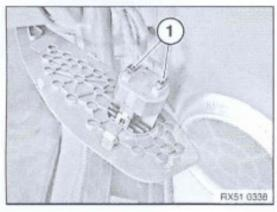
Nur bei SA Beifahrerairbag-Deaktivierung: Steckverbindungen (1) entriegeln und trennen.
