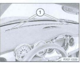
Schrauben (1) in Lüftungsgitter lösen.
