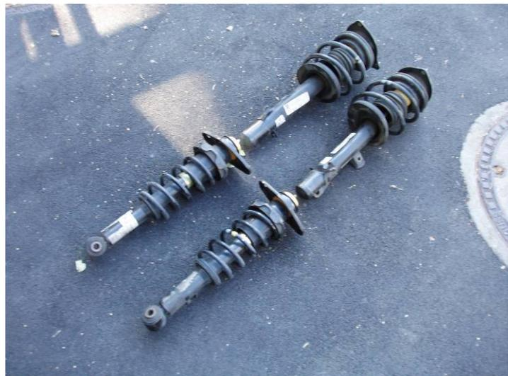
gebunden, bei den VA-Dämpfern muss auf lagerichtigen Einbau geachtet werden. Mithilfe des Druckluftschraubers waren die neuen Federbeine innerhalb weniger Minuten einsatzbereit. Also wieder ran an den MINI und Einpassen der neuen
