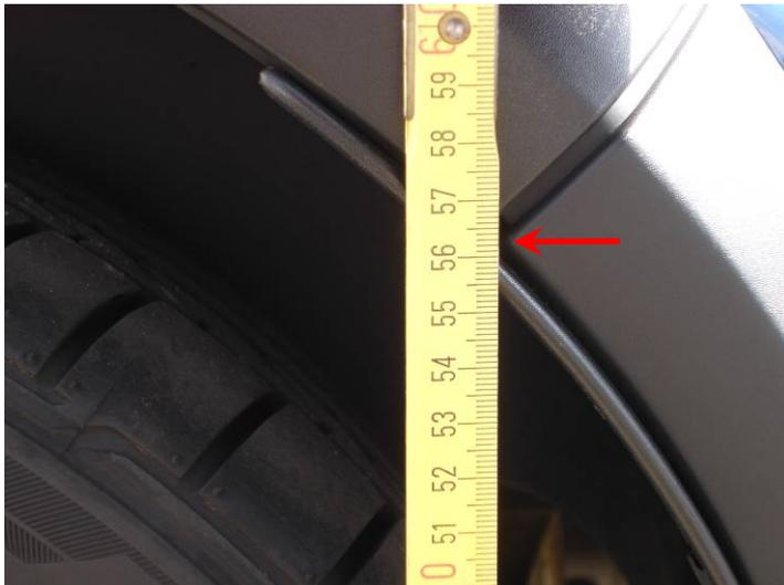
Bei allem vorerst geäußertem Lob darf eine weniger schöne Feststellung hier nicht verborgen bleiben: das Auto kommt seit dem Dämpfereinbau etwas „hochbeiniger“ daher. Durch den neuen Dämpfersatz federt der Wagen etwas weiter aus. 8 Millimeter an der Hinterachse sind nicht viel, jedoch reicht es, den negativen optischen Eindruck zu untermauern. Messpunkt war die im linken Bild durch den Pfeil
