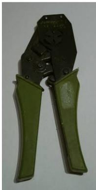
Eine Crimp-Zange für Kabelschuhe
