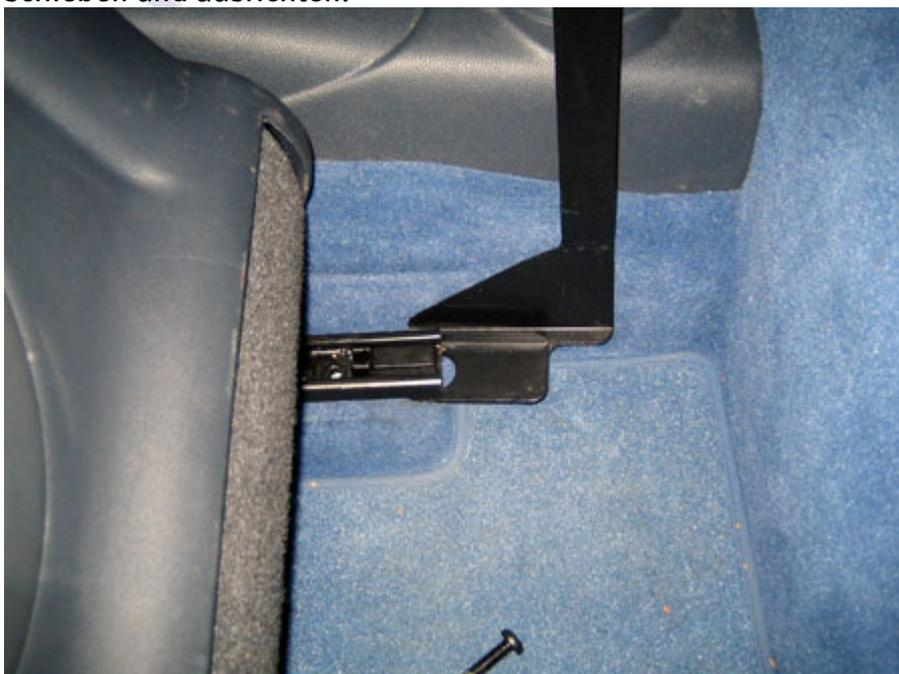
Nun muss man auf beiden Seiten die Schrauben mit aufgetragener Schraubensicherung (z.B. Loctite) wieder festziehen.
