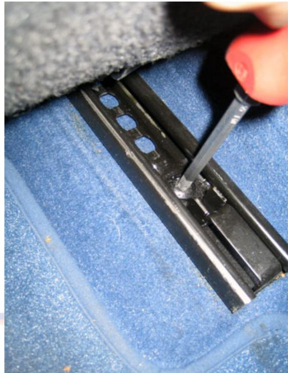
Sobald diese Schrauben gelöst sind, kann man die Mittelarmlehne über den Mitteltunnel stellen. Am einfachsten ist es, wenn jetzt auf beiden Seiten die Sitzschiene leicht hoch gehobelt wird. Dann lässt sich die Mittelarmlehne leicht nach vorne, unter die Schienen schieben und ausrichten.
