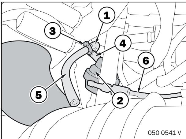
Schlauch (1) von der Unterdruckdose (2) am Kompressor abziehen und an T-Stück (3) anstecken. Schlauch (4) an Unterdruckdose (2) anschließen.
