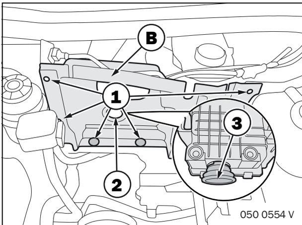
Trennwand **B** mit den vorhandenen Schrauben (1) der Serien-Trennwand anschrauben.
