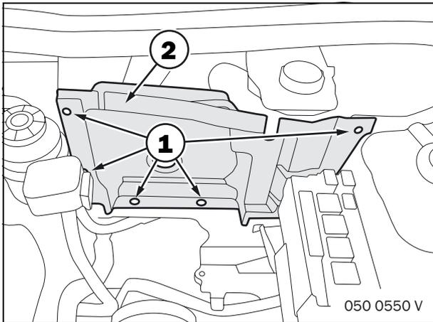
Schrauben (1) lösen und Trennwand (2) entfernen.
