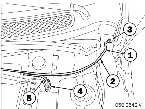
Kabel SW (1) von Verkabelung Trennwand **B** mit Kabelschuh durch Tülle (2) führen und an Massebolzen (3) anschließen. Kabel (4) zur Aussparung (5) verlegen.
