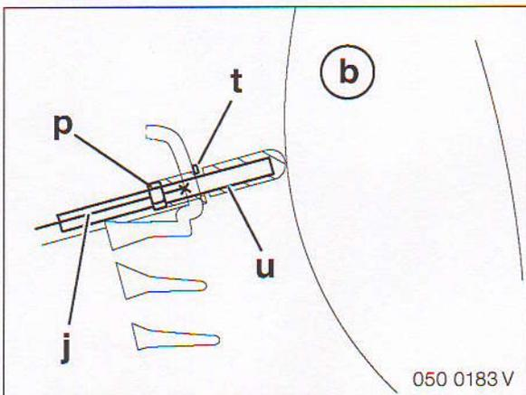
**!** Bei Kombination von CVT-Getriebe und Aeropaketgrill Überstand des Gewindestifts **j** hinter Sechskantmutter **p** auf 5 mm kürzen. ◀
