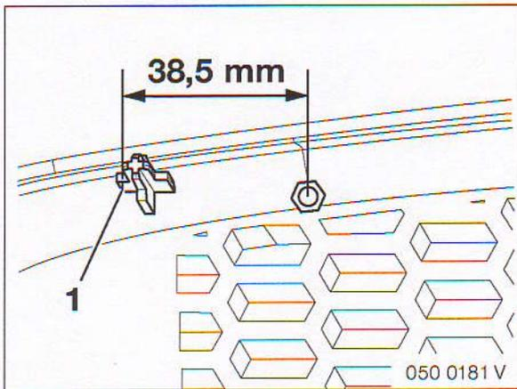
Von der äußeren Kante des Pins (1) das Maß 38,5 mm zur Mitte des Grills anzeichnen.
