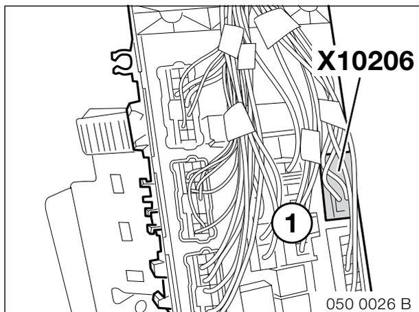
Sicherungskasten (1) lösen und X10206 abstecken.
