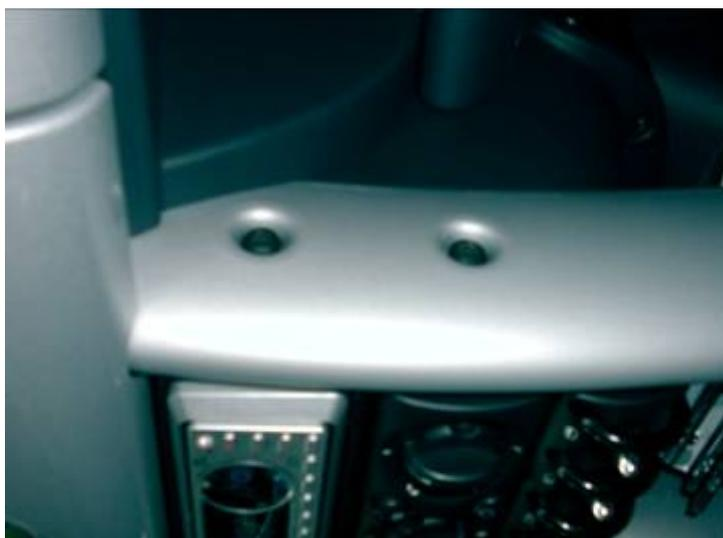
Entfernen Sie dann an dem rechten und linken Holmen jeweils die zwei Schrauben. Entweder mit dem speziellen TORX-Schraubendreher, oder mit einem breiten Schlitz-Schraubendreher, der hineinpasst. Bei der oberen Schraube neben der Lenksäule ist es etwas schwierig. Stellen sie das Lenkrad in die höchste Lage, dann sollte es klappen.
