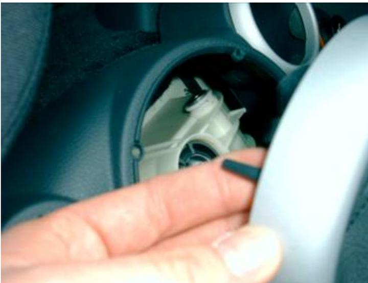
Dann einfach alles wieder zusammenbauen. Bedenken sie dass alles locker sitzt und sie es nicht mit Gewalt in die Befestigungsposition drücken. Die Stecker an dem Spiegelversteller passen nur einmal. Der Rahmen des Schaltsackes hat eine Nase, diese muss auch in die dafür vorgesehene Lochöffnung!
