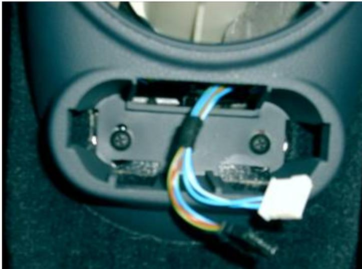
Die Stecker vom Modul abziehen. Dort befinden sich ebenfalls zwei Schrauben, welche entfernt werden müssen.
