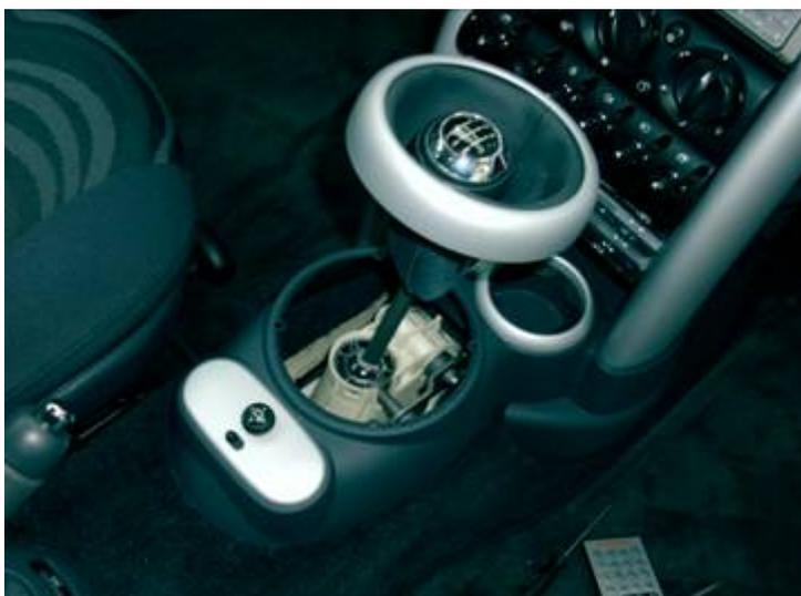
Dann wird der Schaltmanschettenring mit beiden Händen senkrecht nach oben abgezogen.
