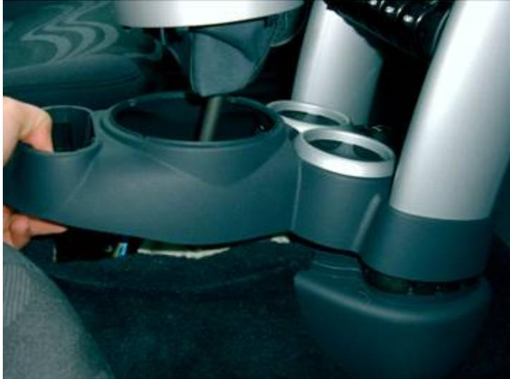
Heben sie die komplette Konsole hinten etwas an. Ziehen Sie die Konsole vorsichtig nach hinten und die silbernen Holme nach unten bis sie am oberen Ende frei liegen.
