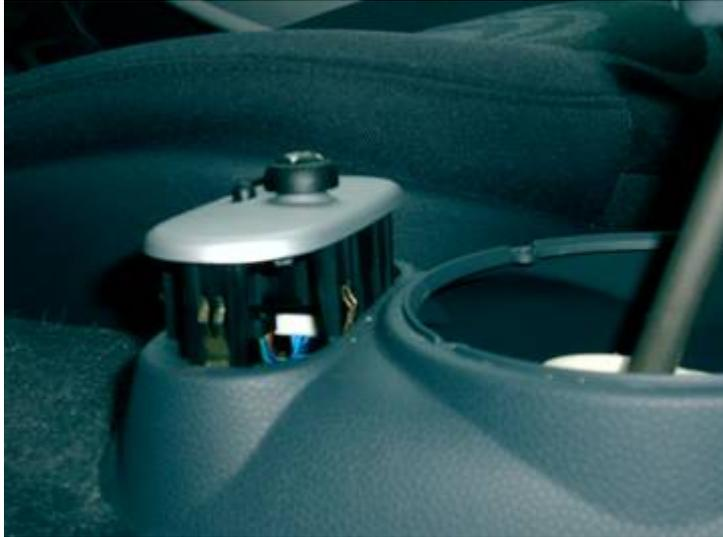
Dann wird das Spiegelverstellmodul ausgebaut indem sie vom Schalthebelloch aus, mit einem Finger dieses nach oben hin herausdrücken
