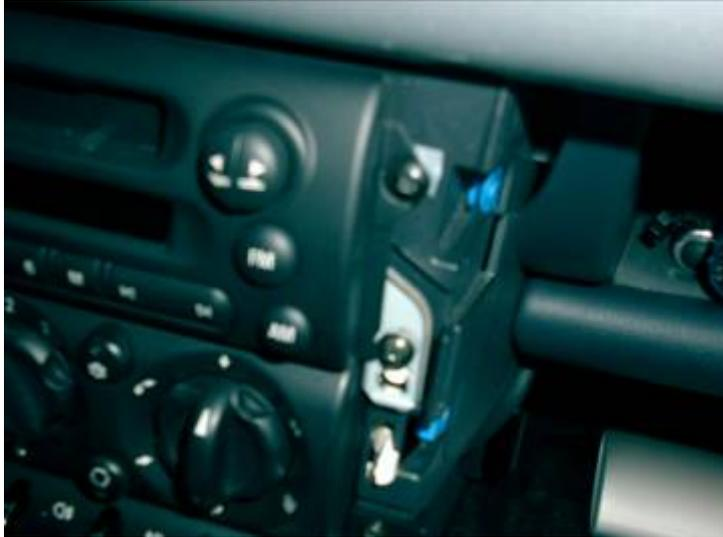
Rechts und links neben dem Radio sind jeweils zwei Schrauben. Diese auf beiden Seiten entfernen und das Radio nach vorn herausziehen
