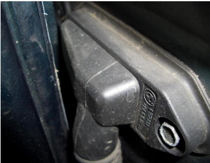
Schraube lösen und mit Geschick den Gummischlauch vom Stecker ziehen (vorne hoch und nach hinten wegdrücken).
