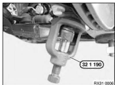
Vor dem Abziehen des Querlenkers die sichernde Schraube (M12) entfernen und beiseite legen. Querlenker vom äußeren Kugelgelenk mit entsprechendem Abzieher entfernen. Sollte kein Abzieher zur Verfügung stehen ist es ebenfalls möglich mit einigen gezielten Hammerschlägen den Querlenker aus dem Kugelgelenk zu schlagen.
