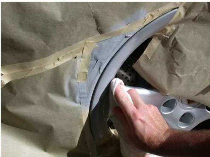
Die Schadensstelle wird nun mit 600er Papier fein im Naßverfahren geschliffen und für die Lackierung vorbereitet (SiliconEntferner verwenden).
