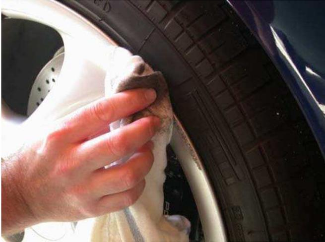
Im nächsten Schritt wird die Felge kleinfächig abgelebt, damit keine Rückstände beim Spachtel entstehen können.
