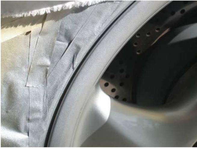
Kleine Lackrückstände werden nun wieder mit Hilfe von Nitroverdünnung entfernt.
