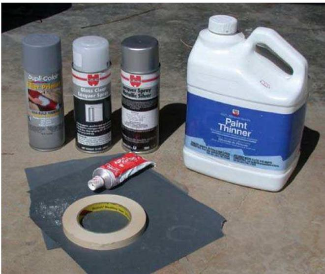
Würth Felgensilber, Nitroverdünnung, SiliconEntferner, Klarlack, Füller bzw. Grundierung, Schleifpapier z.B 240er und 600er und ein Nitrospachtel oder sogenannter Spot Kit.
