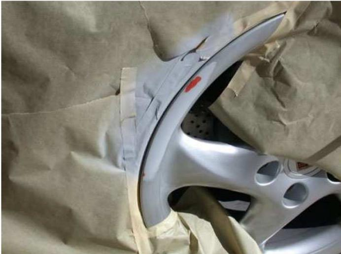
Nach der Trocknungszeit, werden Überstände mit Hilfe von der Nitroverdünnung entfernt.
