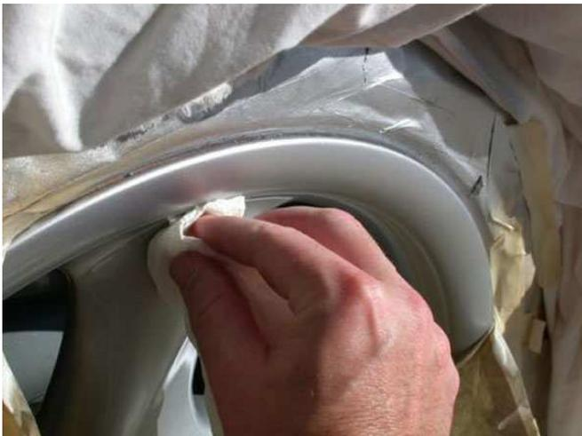
Danach wird der Klarlack auch wieder in mehreren Kreuzgängen auflackiert . Nach dem Durchtrocknen und entfernen der Abklebestellen kann man die leichten Übergänge anpolieren. Das Lackbild sollte übergangsfrei und ohne Schattierung ausfallen.
