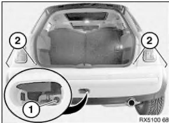
Schraube (1) in Öffnung für Rückfahrleuchter herausdrehen.
