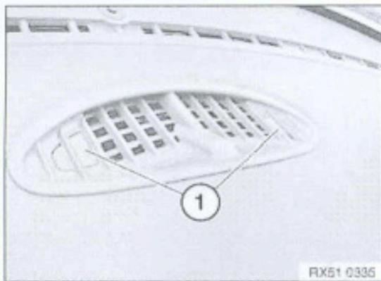
Abdeckkappen (1) im Lüftungsgitter ausheben und darunter liegende Schrauben lösen.
