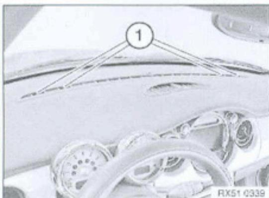
Schrauben (1) in Lüftungsgitter lösen.
