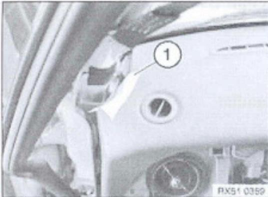
Verkleidung mit Klebeband (1) vor Beschädigungen schützen.
