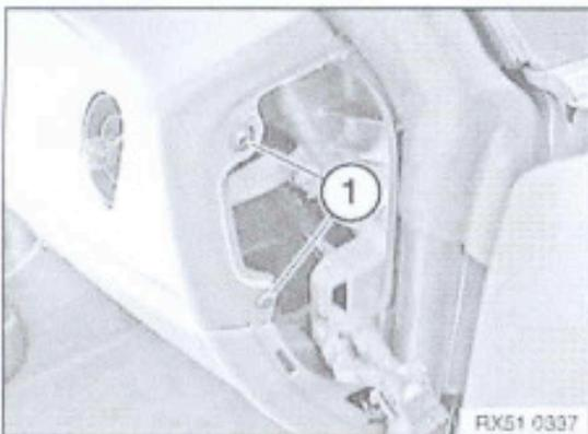
Schrauben (1) links und rechts lösen.
