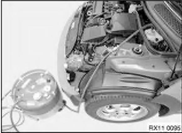
Entlüftergerät am Ausgleichsbehälter anschließen und einschalten.
