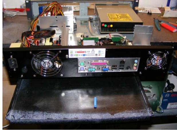
Hier ist die Vorderseite zu sehen. Das CD-Rom wird nur zum Installieren oder für Updates benötigt. Normalerweise verschwindet es hinter einer Blende, die entsprechend wie die rechte, neu lackierte und beschriftete Blende aussieht:
