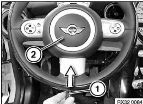
Torxschraubendreher T25 (1) in die mittige Öffnung am Lenkrad einführen und in Pfeilrichtung nach oben drücken, bis die Airbageinheit (2) entriegelt hat.
