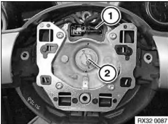
Räder / Lenkrad in Geradeausfahrstellung bringen.
