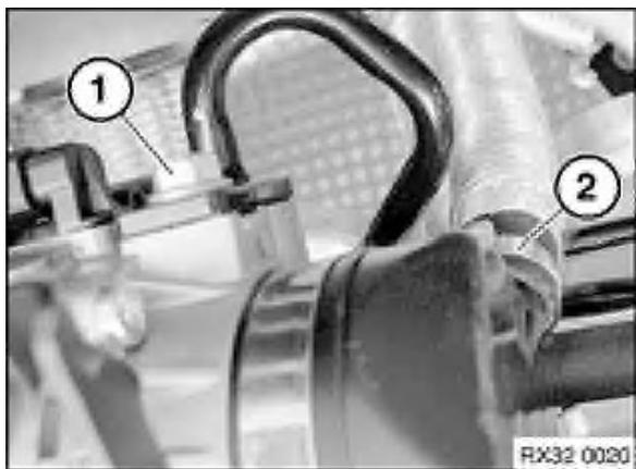
Schraube (1) lösen und Druckleitung abbauen.
