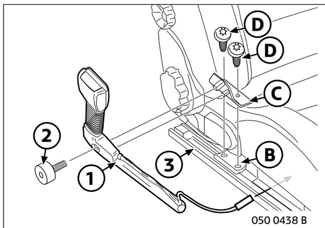
Befestigungswinkel **C** mit Schrauben **D** am Sitzrahmen **B** und Sitzschiene (3) verschrauben.
