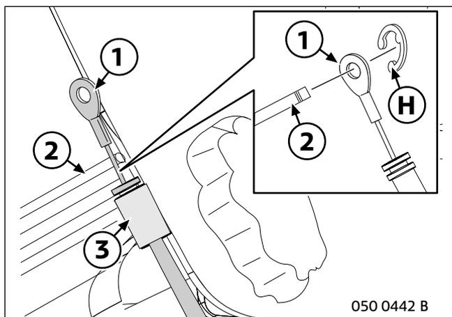
Vorhandenen Easy-Entry Bowdenzug (1) durch Führung (3) verlegen. Öse des Bowdenzuges (1) mit Klammer **H** an Schiene (2) befestigen.
