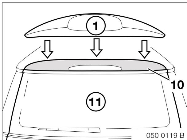
Zubehör-Heckspoiler (1) auf die vorbereitete Fläche (10) der Heckklappe (11) kleben.
