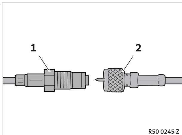
Stecker Antennenleitung (1) und Stecker Antennenleitung der Handyhalterung (2) zusammenschrauben.
