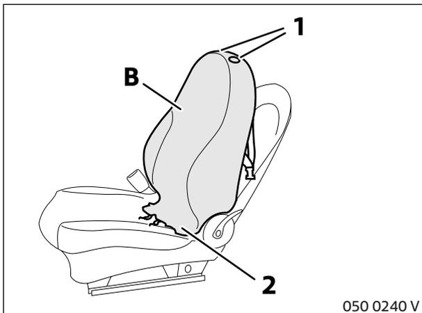
Den Schonbezug **B** auf die Lehne aufziehen und anhand der Kopfstützenaufnahmen (1) ausrichten.
