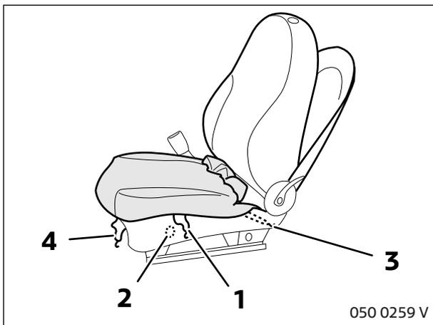
Die vorderen seitlichen Spannbänder (1) durch die beidseitigen Löcher (2) des Sitzgestells durchziehen und unter dem Sitz befestigen.
