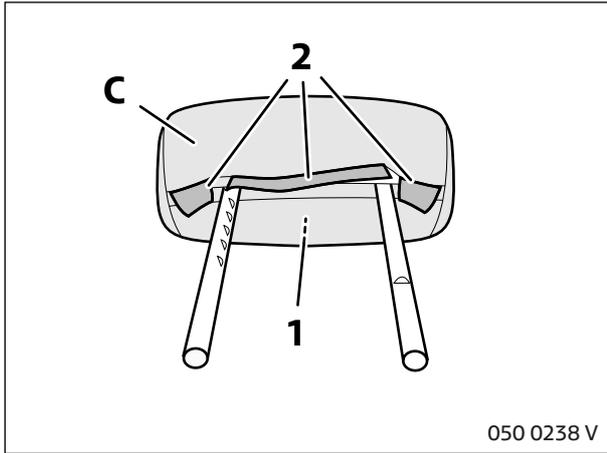
Den Schonbezug **C** auf die Kopfstütze (1) aufziehen und an die Konturen anpassen. Klettverschlüsse (2) schließen.
