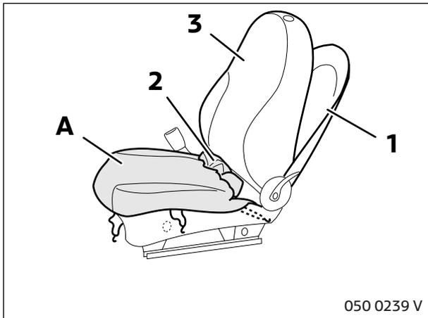
Hinterer Sitzverkleidung (1) im oberen Bereich lösen und nach hinten wegklappen.
