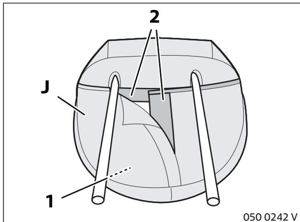
Den Schonbezug **J** auf die Kopfstütze (1) aufziehen und an die Konturen anpassen. Klettverschluss (2) schließen.
