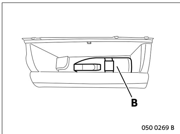
Ablagefach einbauen, Feuerlöscher B einhängen.
