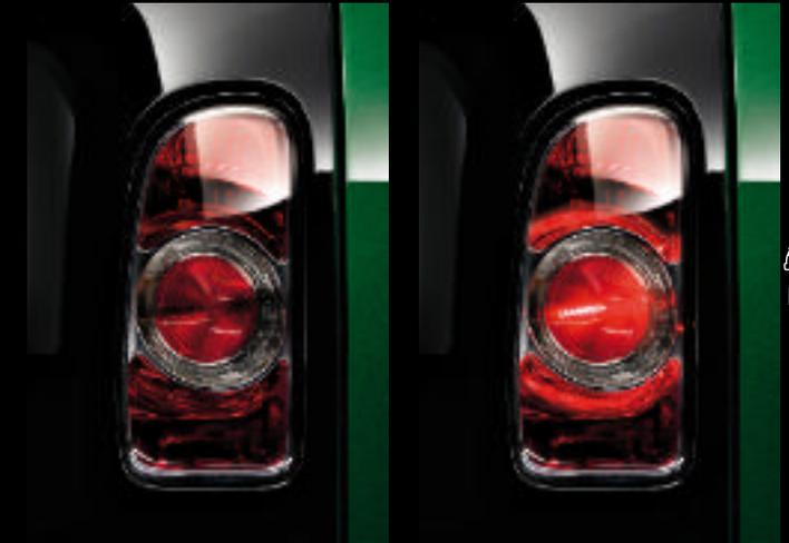
6. LED-Rücklichter mit integrierter Nebelschlussleuchte
