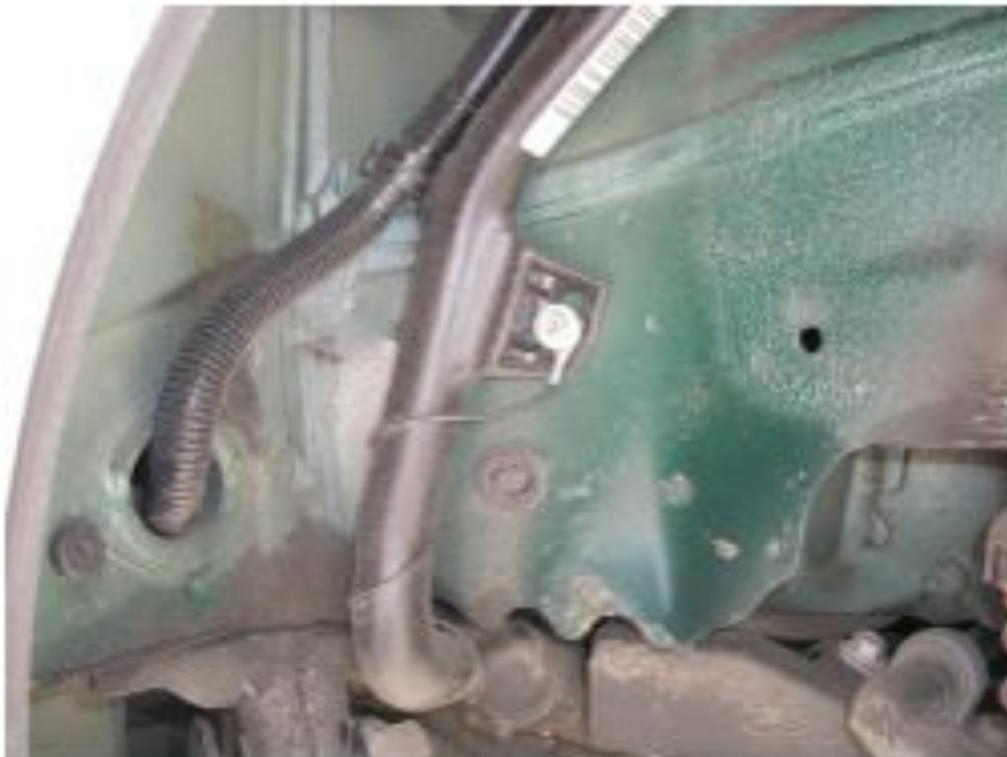
Der Anschluss von der Füllschlange auf den Benzintank. Die hinterste Schlangenklemme lösen. Also die am nächsten zum tank ist.
