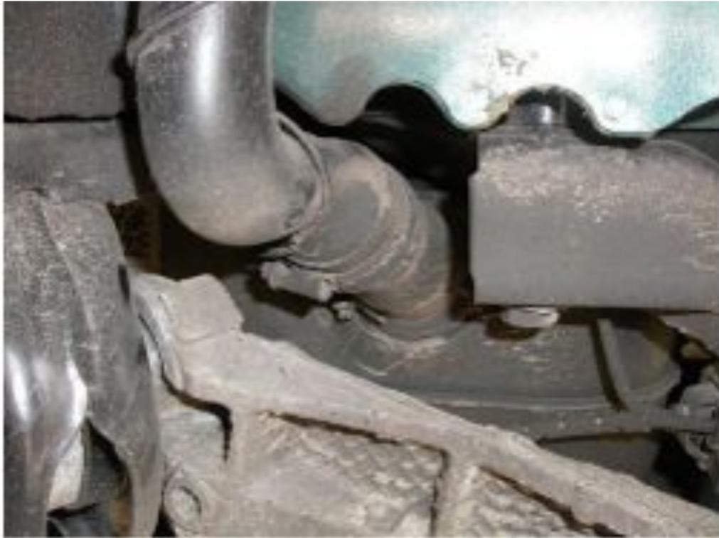
Jetzt kann man die Füllschlange durch drehen/ziehen/bewegen entfernen.
