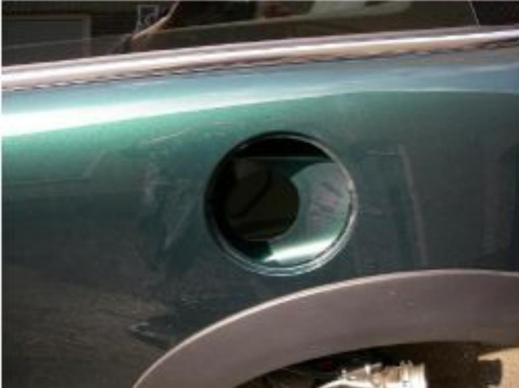
Jetzt kann man die Neue Tankdeckelhalterung festmachen. Pass aber auf das du die Linke Seite im Seitenpanel erst reindrückst. Um zu verhindern das du nach dem einsetzen nicht mehr an den Verriegelungspinn kommst, Kann man etwas dran befestigen (im Foto ist es eine dünne Schlange). Weil wenn die Tankdeckelhalterung einmal sitzt kannst du nie mehr an die Verriegelung ran!!!! Wenn die Haltung sitzt muss noch die Gummidichtung an der Rückseite wieder ordentlich eingesetzt werden ( siehe 5e Foto ).
