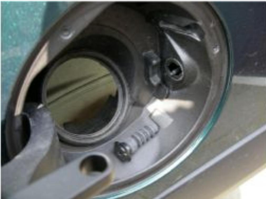
Auf dem Foto hier drüber sieht man 2 kleine Vertiefungen in dem Rand auf 11 und 3 Uhr. Hier soll man mit einen kleinen Torx Schraubendreher, oder etwas ähnliches durchstechen, wodurch die Kunststoffklemme die sich dahinter befinden wegdrückst.
