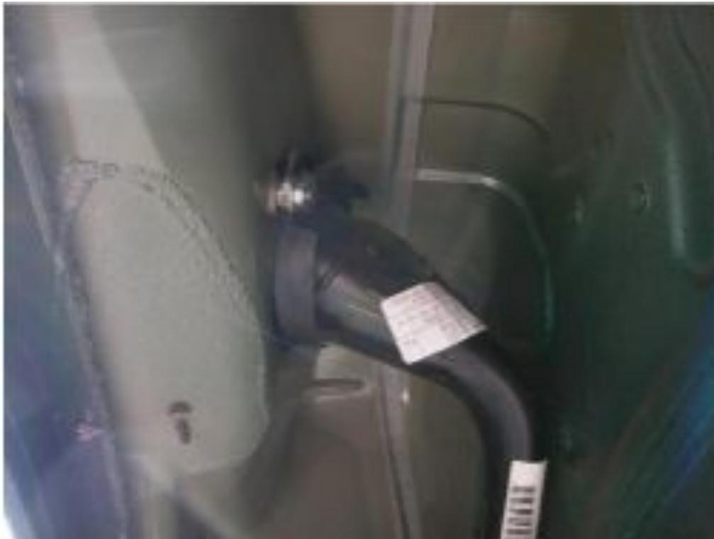
Die Befestigung von der Füllschlange, auch diese Mutter ( 10 ) entfernen.
