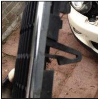
7. Als Nächstes können die Halter dran. Dazu die Torx Schraube und die Mutter wie auf dem Foto sichtbar lösen. Einfach ab! Passiert nix!
