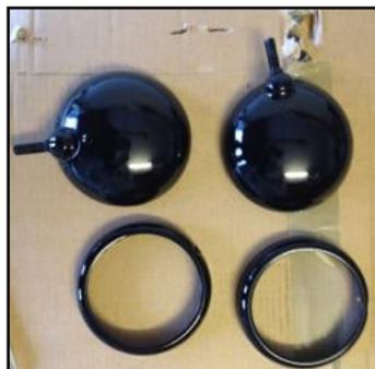
4. Am besten die lackierten Teile über Nacht bei Raumtemp trocknen lassen!
