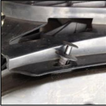
6. Anschliessend den Grill unten lösen. Hierzu von den Seiten und von Oben mit einem langen Schraubenzieher die langen Klammern leicht eindrücken und den Grill dabei nach Vorn rausziehen. Geht ganz leicht!
