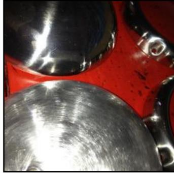
2. Gehäuse mit Haftgrund grundieren. Im ersten Gang nur ein leichtes Netz sprühen. (Tipp: Nach jedem Sprühgang mit einem Fön warm in kleinster Stufe den Lack antrocknen. So gibts keine Nasen und man kann schneller Arbeiten)
