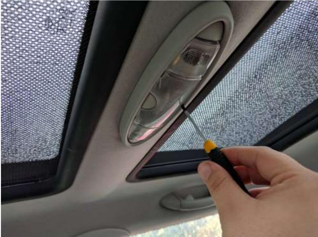
Die Abdeckung abnehmen und schon kann man die Soffitte tauschen. Mit entsprechendem Werkzeug kann auch die W5W Lampe getauscht werden.
