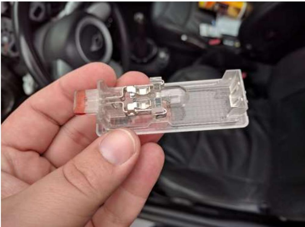
Bauartbedingt müssen die LED Lampen mit etwas Schrumpfschlauch oder Klebeband isoliert werden. Sonst kann es zu einem Kurzschluss kommen.
