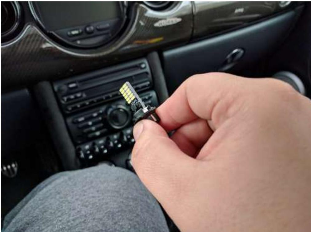
Die LED evtl. etwas schräg einbauen. Bei mir blieb die LED am Rahmen hängen, dies ließ sich durch das anwinkeln vermeiden.
