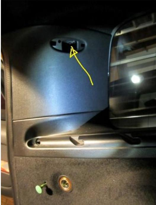
Die Träger für den Doppelten Boden abziehen, die Gepäckösen abschrauben. Bild 3
