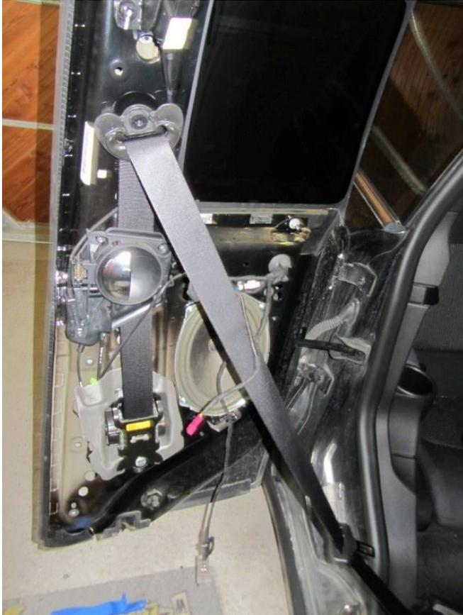
dann die Leuchte unten abklebten und mit einem flachen Keil die Türverkleidung abklipsen.
