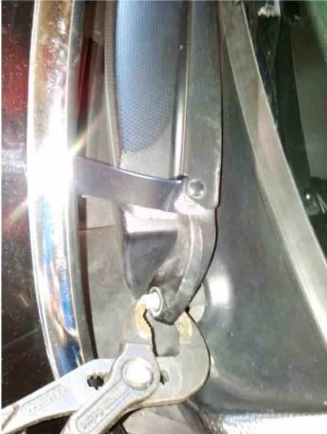
Plastikverkleidungen weg und wir finden eine grosse Gummitülle zum Fussraum Fahrerseite...wenn wir schon soweit sind gleich ein Kabel für die Zusatzinstrumente reinfrimmeln :,) 🍀
