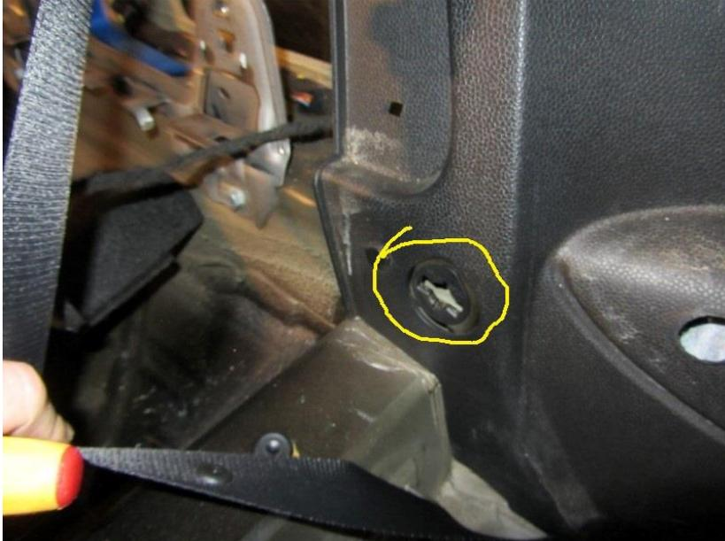
Die Sitzfläche ist nur vorne an 2 Hacken eingerastet, einfach anpacken und nach oben abziehen. Die Schwellerleiste Fahrerseite abklipsen und jetzt kann die Verkleidung linke Seite hinten weggeklipst werden !!!
