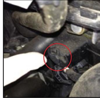
2. Jetzt muss der Ansaugschlauch vom Luftfilter aus dem Weg. Hierzu mit einem Schraubenzieher die Schelle um den Schlauch am unteren Ende lösen. Dann den Schlauch "abdrücken". Bei mir war da etwas Druck notwendig. Kann aber nichts kaputt gehen, also ab mit dem Teil!
