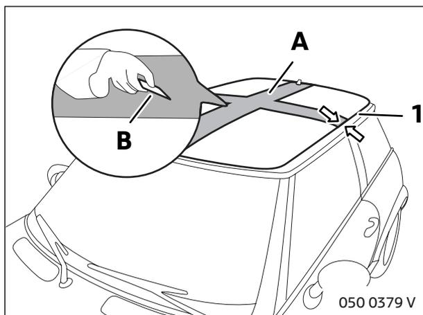
Trägerelement **A** mittig auf dem Dach ausrichten. Dazu auch den Abstand des Foliensegmentes rechts und links zur Dachleiste (1) abgleichen.
