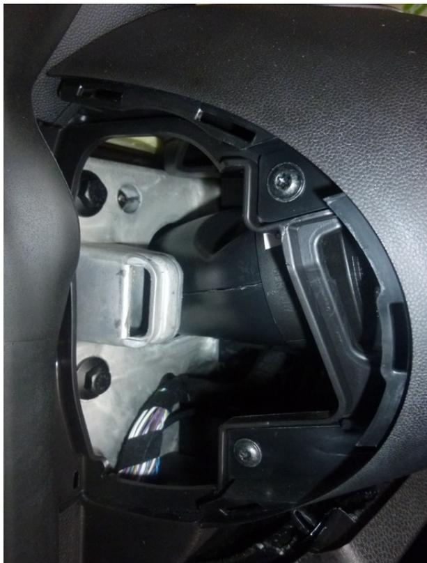
Die 3 Befestigungs-Schrauben (20er Torx) der Lüftung lösen (zwei Schrauben sind sichtbar - siehe oberes Bild - und eine Schraube befindet sich hinter rechts von der Lüftungsdüse unterhalb des Blendenklips). Die Lüftung ist nun lose und kann etwas zur Seite gedrückt werden. Es entsteht ein Schlitz zwischen dem Armaturenbrett und der Lüftungsdüse.
