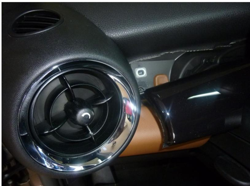
Kleine Blende bei der linken Lüftung mit einem stumpfen Gegenstand entfernen
