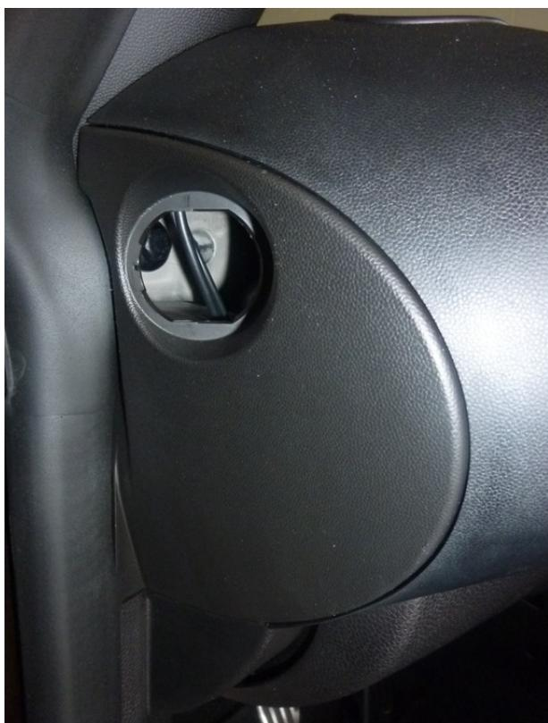
Die grössere Blende ebenfalls entfernen: Mit den Fingern im entstandenen Hohlraum hineinfassen und einen Ruck geben und die Blende zur A-Säule hin wegdrehen, da sie dort eingehängt ist.
