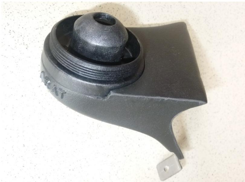
Bei der Bildschirmaufnahme sind teilweise noch Ergänzungen vorzunehmen. So musste in meinem Fall von der originalen Saugnapf-Halterung der Navi-Halter mit dem Kugelgelenk und der Gelenkpfanne an die neue Bildschirmaufnahme montiert werden. ARAT sendet hierfür aber detaillierte Montageanleitungen mit.
