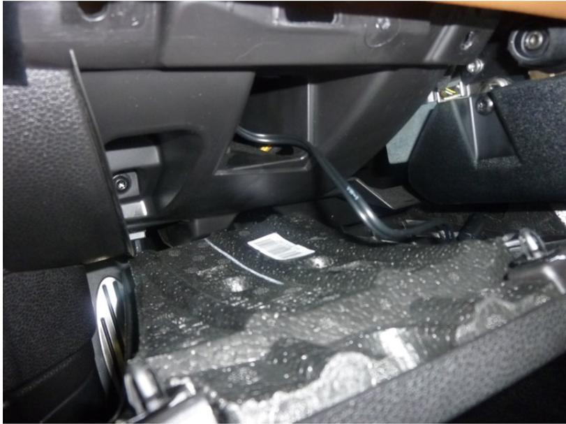
Das Stromkabel führen wir im unteren Bereich der Lenkrad-Abdeckung ein und stecken den Stecker im 12V-Anschluss ein.
