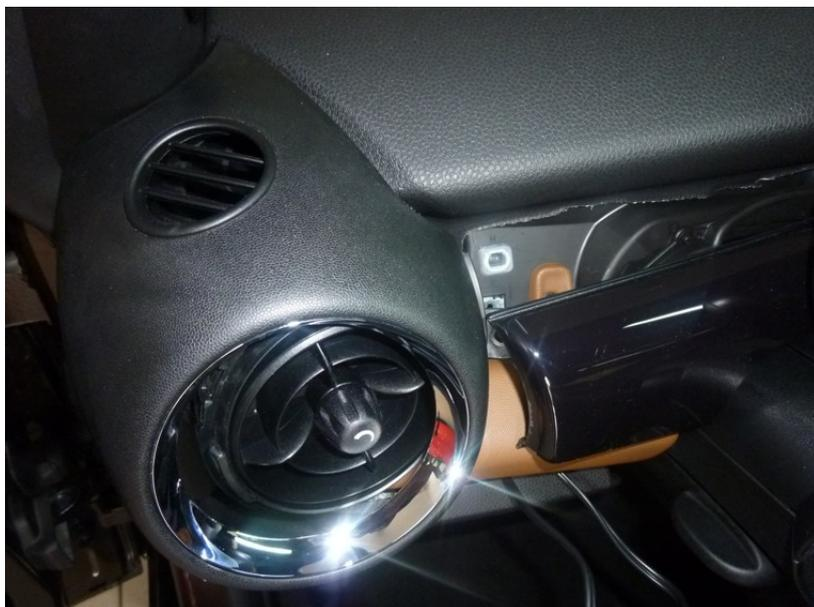
Die Halterung kann mit der Blechnase in den entstandenen Schlitz gedrückt werden und ausgerichtet werden. Anschliessend muss sie mit der beiliegenden Schraube (Linsenkopf-Schraube 4,2 x 13mm) durch die Blechlasche in die Fahrzeug-Armatur verschraubt werden (Mit einer Ahle etwas "vorbohren").
