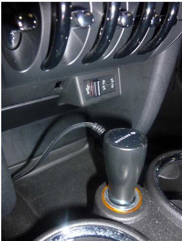
Dann ziehen wir das Kabel von der Mittelkonsole weg in Richtung Lenkrad-Abdeckung und drücken es in die entsprechenden Kunststoffübergänge (im Bild der linke Lüftungsauslass für den Fussraum bei der Mittelkonsole).
