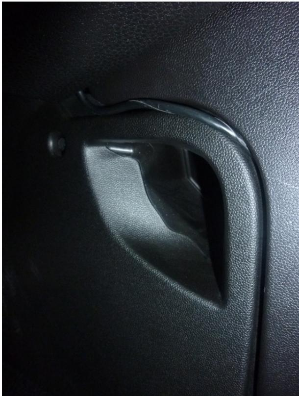
Nun kommt der Schritt, welcher am meisten Geduld benötigt: Das Kabel wird nun zuerst von der Lenkradabdeckung innen zur Lüftung, und von dort zur noch losen Lüftungsdüse geführt, sodass es beim Übergang von der Lüftungsdüse zur Interieurleiste sichtbar wird.
