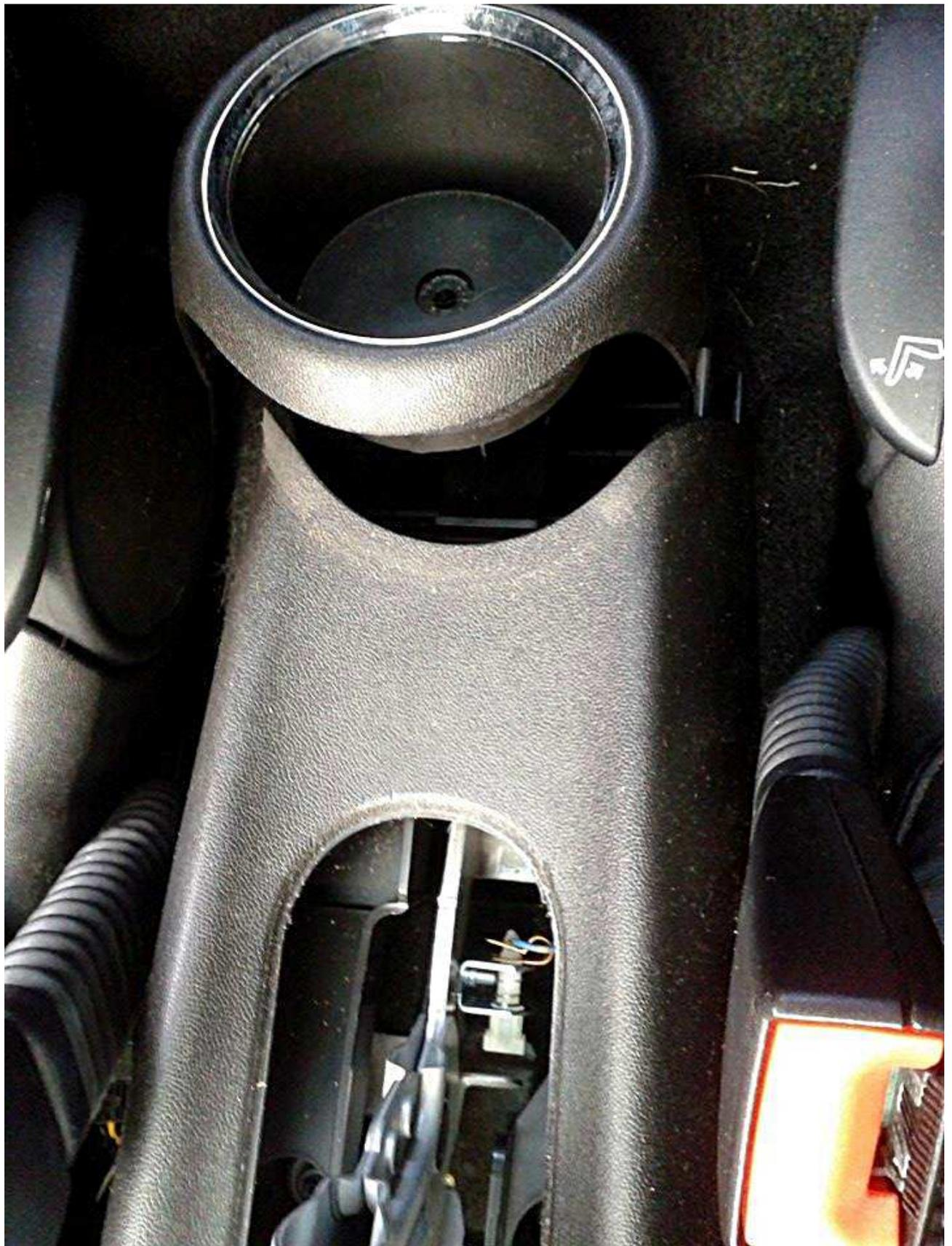
**3. Handbremskonsole lösen und beiseiteschieben. Hierzu die 2 Schrauben in den vorderen Getränkehaltern entfernen. Danach die Konsole nach oben abziehen (4 Halteklipse beachten) und die Konsole zur Seite weg schieben.**
