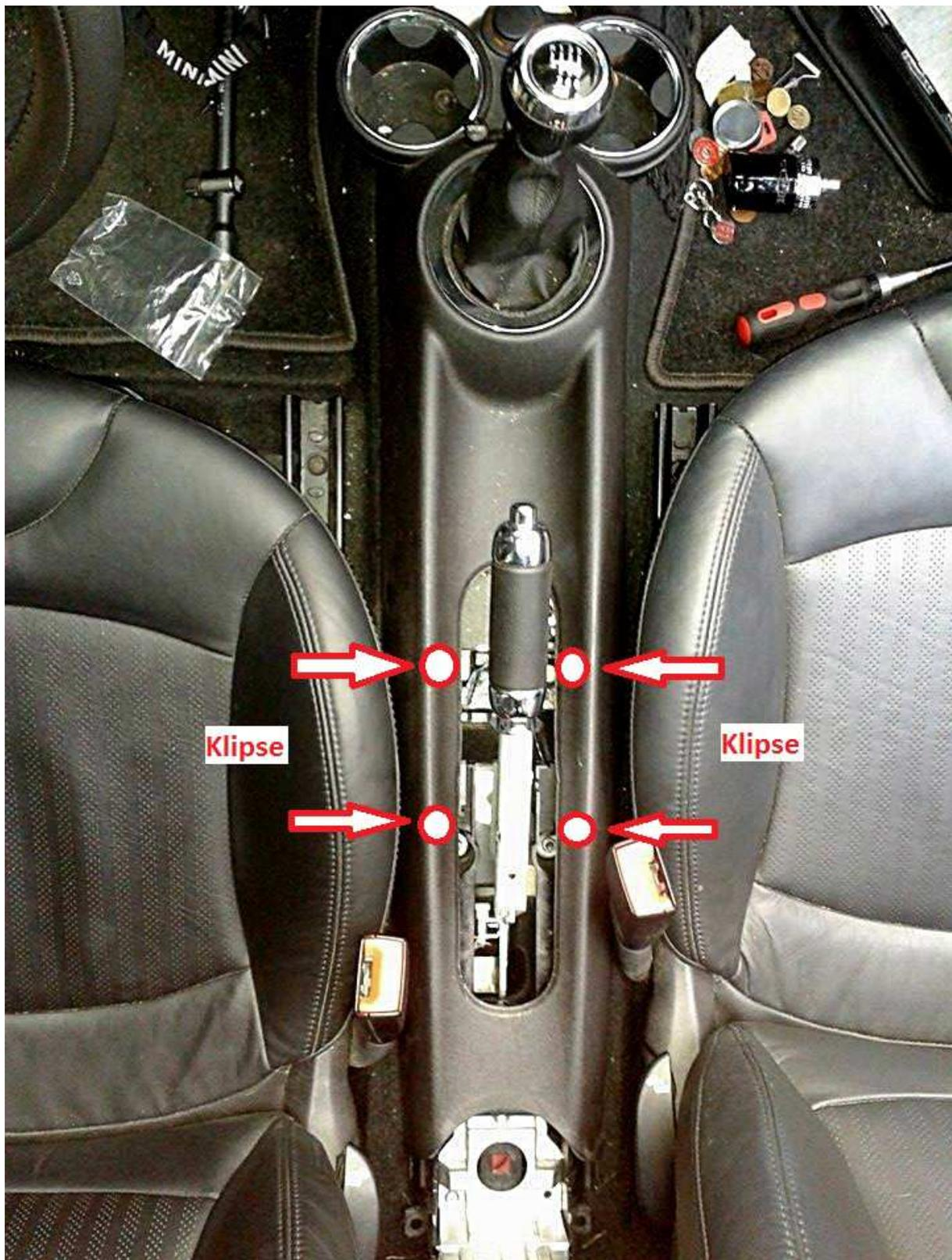
4. Den Halter der Handbremskonsole entfernen und durch den neuen ersetzen. Hierzu alle 4 Muttern entfernen und den Halteclips (Kabel der Handbremse) abstecken. Halter der Handbremskonsole nach oben abziehen. Neuen Halter drauf setzen. Clips vom Kabel wieder einstecken und alle 4 Muttern fest ziehen.
