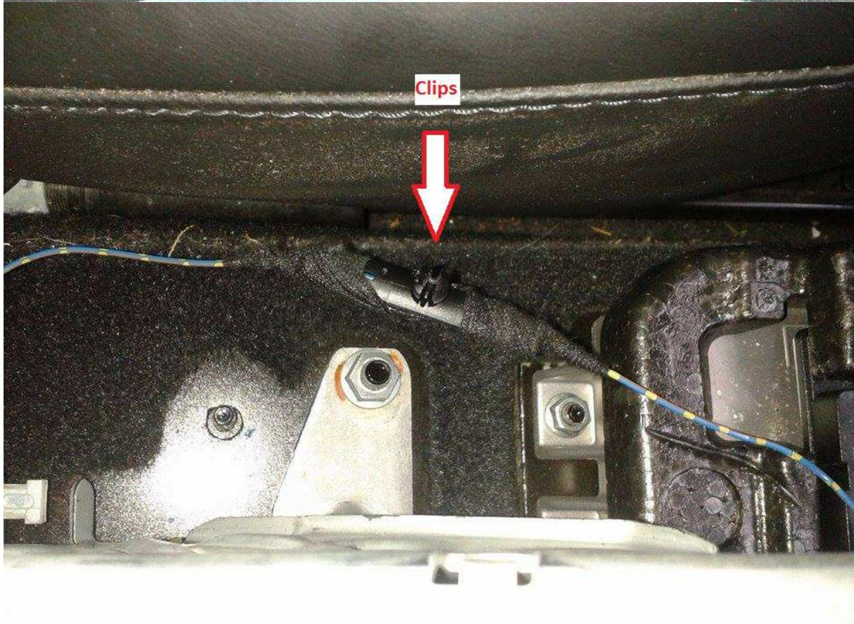
5. Neuen Halter drauf setzen. Clips vom Kabel wieder einstecken und alle 4 Muttern fest ziehen.
