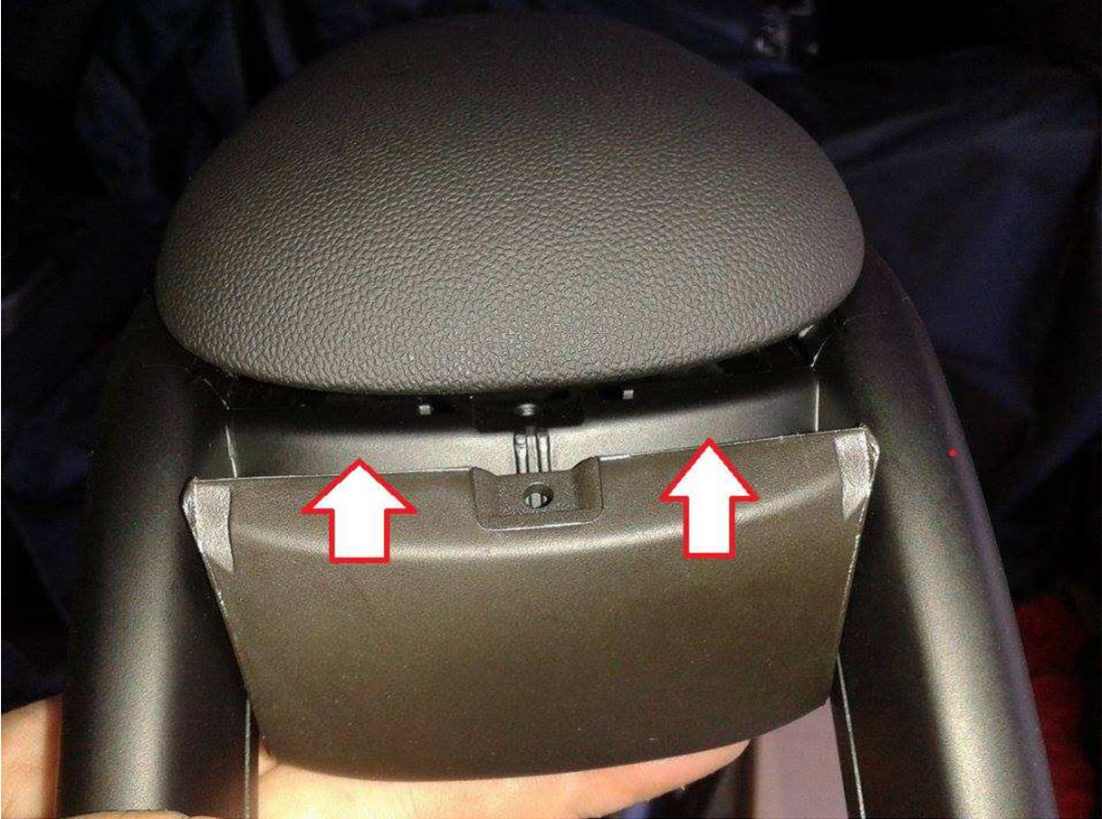
7. Mittelarmlehne in den Halter der Mittelkonsole einstecken und mit 3 Schrauben festziehen.
