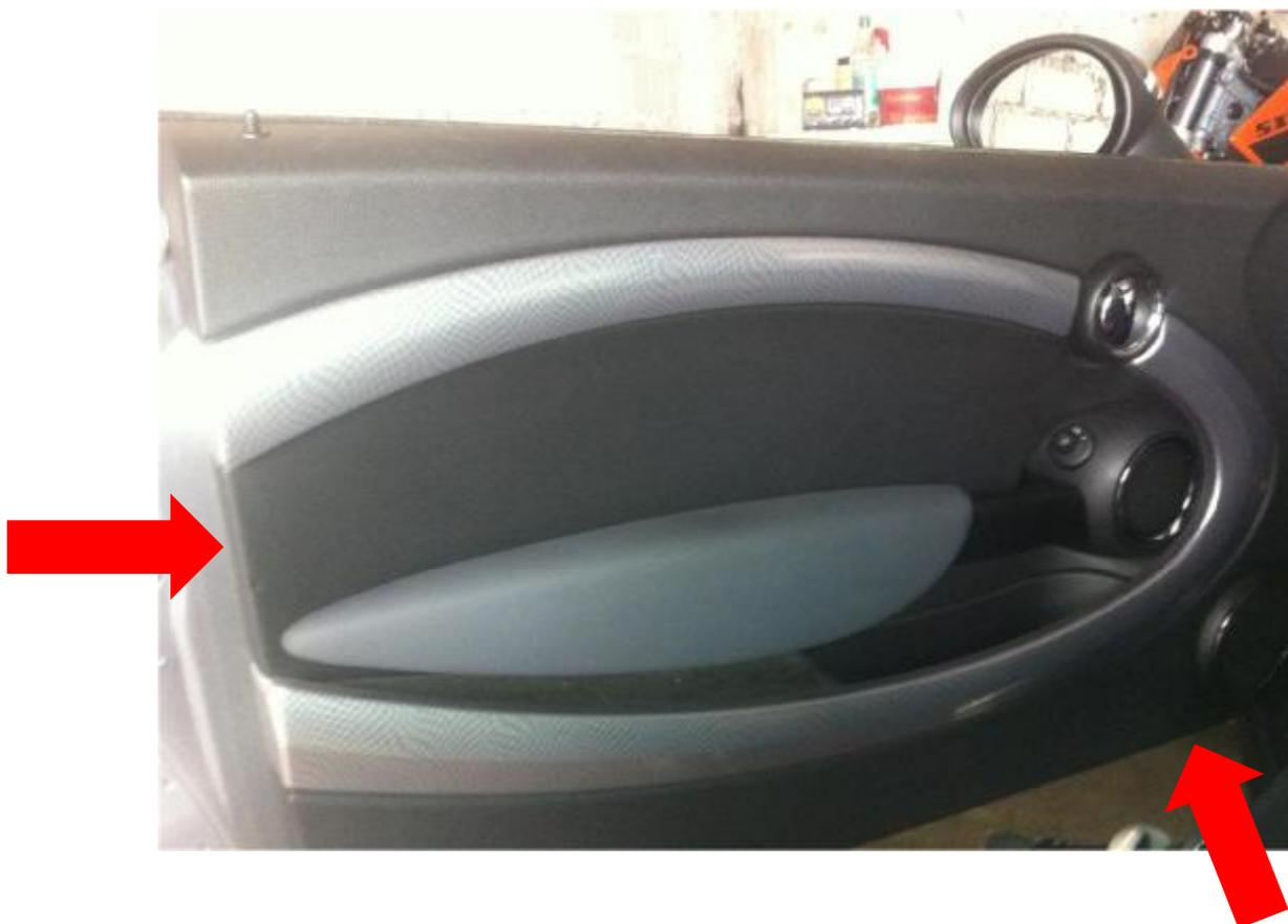
Hat man alle Klipse gelöst ist ein wenig Vorsicht angebracht. Nun besteht noch eine Steckverbindung für das Licht, welches unter der Tür ist. Diese einfach abklipsen. Dann sollte man noch Acht auf den „Türöffnerknopf“ geben. Hier muss die Verkleidung drüber gehoben werden. Eure Tür sollte dann wie folgt aussehen (markiert die Steckverbindung für das Licht unter der Tür):
