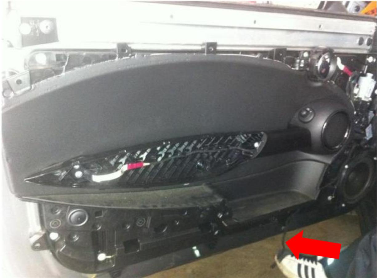
Nun müsst ihr einen ganzen Haufen Torxschrauben lösen. Diese befinden sich ringsum um die noch vorhandene Verkleidung. Ebenso die Schrauben an der Aluschiene. In der Armablage befindet sich auch eine Schraube, die gelöst werden muss.
