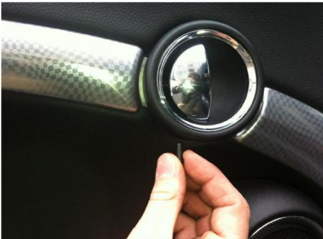
Auf folgendem Bild zu sehen: Die Armablage ausklipsen. Hintergreifen und abziehen, geht recht einfach:
