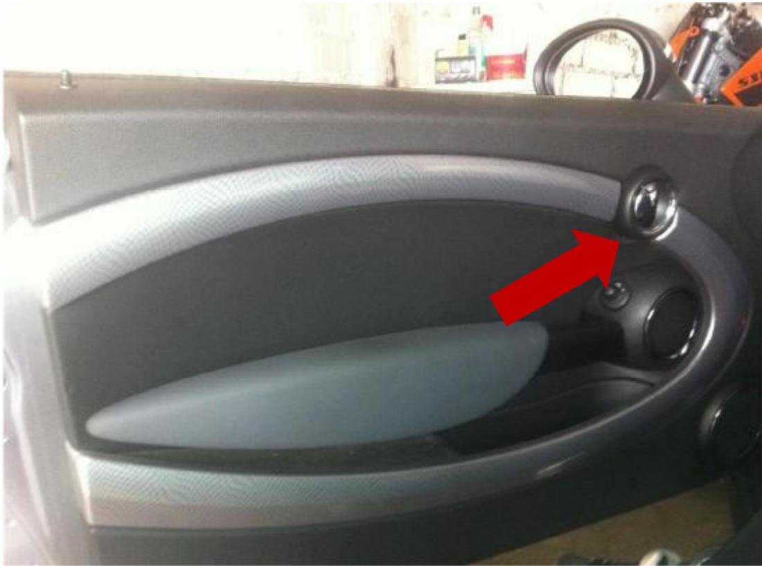
Am Pfeil befindet sich ein kleiner „Stift“. Diesen mit einem flachen Schraubendreher raushebeln und rausziehen. Danach lässt sich der Ring abnehmen. Siehe Bild:
