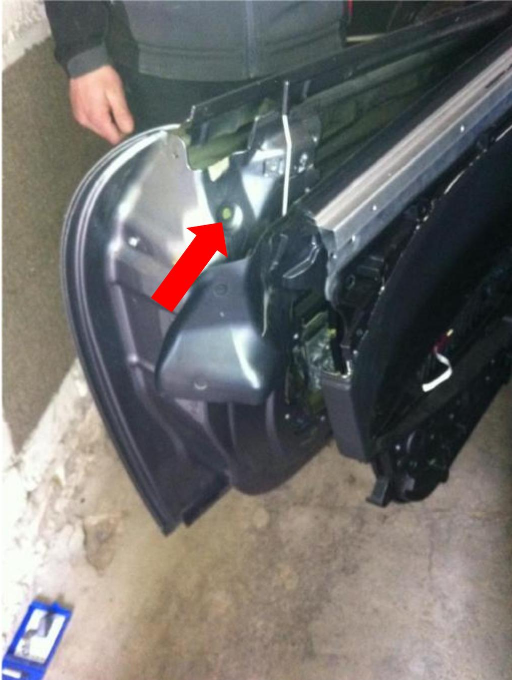
Durch das markierte Loch sieht man eine Inbusschraube. Diese lässt sich mit einem Kugelkopf Inbus gut lösen. Die andere lässt sich mit einer kleinen Ratsche von Innen lösen.
