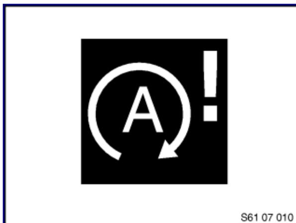
Liegt ein Fehler innerhalb der ASSF-Hardware vor, der zur Deaktivierung der Auto Start Stopp Funktion führt, wird eine CC-Meldung angezeigt.
