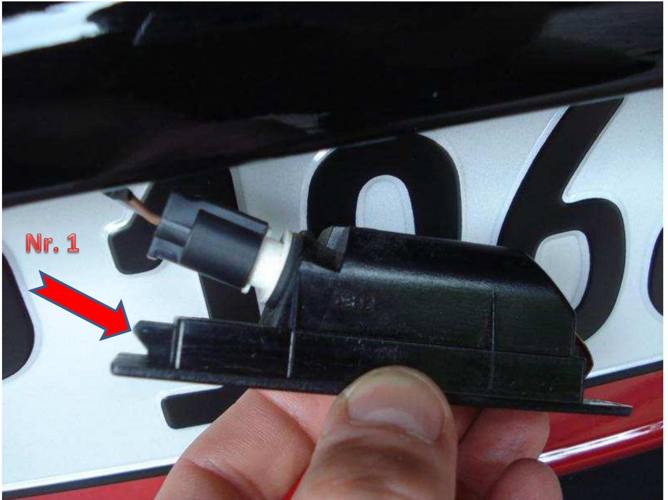
So schaut die Leuchten Einheit im ausgebauten Zustand aus
