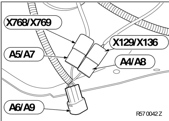
Abzweige **A4-A5** wie folgt an linker Fahrzeugseite anschließen:
