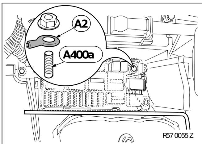
Stromverteiler **A400a** im Motorraum Befestigen.
