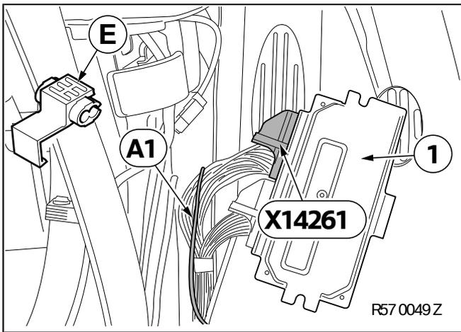
Abzweig **A1**, Kabelfarbe BL, mit Mini-verbinder **E** am Kabel aus Pin 12 des Steckers **X14261**, Buchsengehäuse 51-pol. SW, des Fußraummoduls (1) anschließen.
