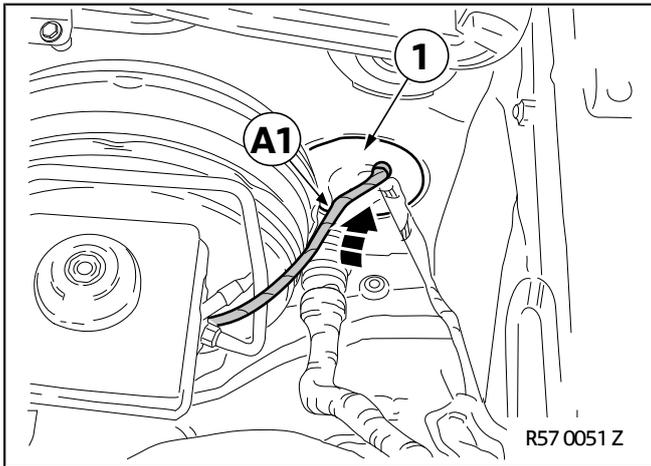
Abzweig **A1** durch Gummitülle (1) der Trennwand in den Fahrzeuginnenraum verlegen.
