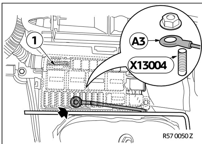
Stromverteiler **A400a** im Motorraum lösen und zur Seite klappen.
