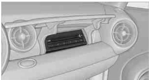
Der MINI CD-Wechsler für sechs CDs ist in der Armaturentafel untergebracht.
