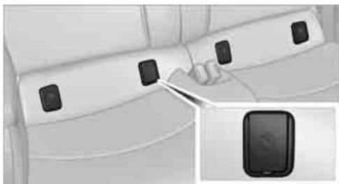
Die Aufnahmen für die unteren ISOFIX Verankerungen befinden sich hinter den gekennzeichneten Abdeckkappen.
