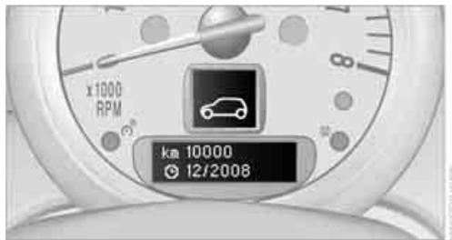
Die verbleibende Fahrstrecke und das Datum für die nächste Wartung werden direkt nach dem Motorstart oder nach Einschalten der Zündung kurz angezeigt.
