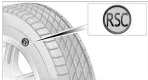
Bereifung mit Notlaufeigenschaften erkennen Sie an dem kreisrunden Symbol mit den Buchstaben RSC auf der Seitenwand.
