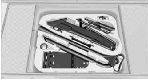
Je nach Ausstattung ist Ihr Fahrzeug mit einem speziellen Bordwerkzeug ausgestattet, das unter dem ebenen Ladeboden untergebracht ist.
