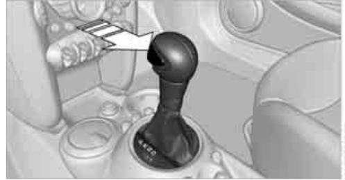
Taste an der Vorderseite des Wählhebels drücken, Pfeil.
