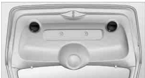
Griffmulden an der Innenverkleidung der Heckklappe erleichtern das Herunterziehen.
