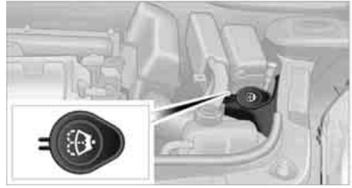
Füllung mit Wasser und bei Bedarf mit Zusatz von Frostschutz nach Anweisung des Herstellers.
