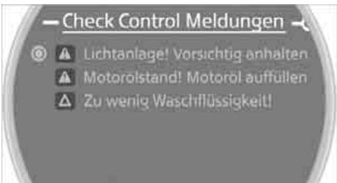
Einige Check-Control-Meldungen werden so lange angezeigt, bis die Störungen behoben sind. Sie können nicht ausgeblendet werden. Sollten einmal mehrere Störungen gleichzeitig
