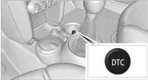
Taste mindestens 3 Sekunden drücken, die Kontrollleuchten für DSC in den Anzeigeelementen leuchten. Dynamische Traktions Control DTC und Dynamische Stabilitäts Control DSC werden gemeinsam deaktiviert. Stabilisierende Eingriffe werden nicht mehr ausgeführt.
