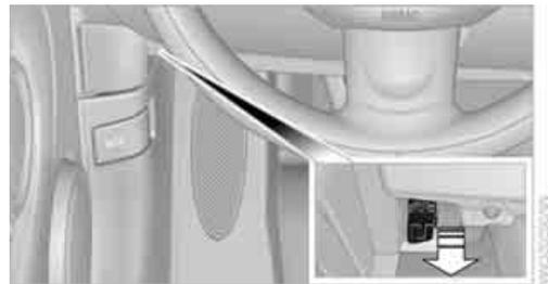
Komponenten, die für die Abgaszusammensetzung maßgeblich sind, können über die OBD-Steckdose mit einem Gerät geprüft werden.
