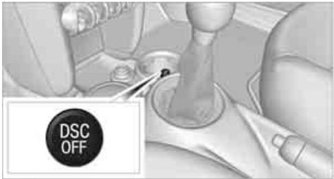
Taste drücken, bis die Kontrollleuchten für DSC in den Anzeigeelementen leuchten. DSC ist deaktiviert. Stabilisierende und den Vortrieb fördernde Eingriffe werden nicht mehr ausgeführt.
