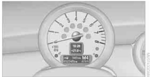
Motordrehzahlen im roten Warnfeld unbedingt vermeiden. In diesem Bereich wird zum Schutz des Motors die Kraftstoffzufuhr unterbrochen.
