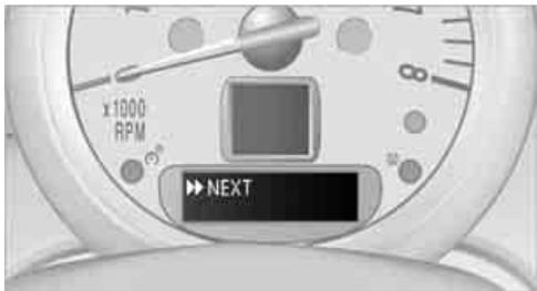
1. Innerhalb einer Einstellung oder Information Taste im Blinkerhebel so oft antippen, bis „NEXT“ angezeigt wird.
