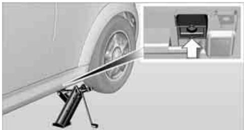
2. Wagenheberkopf beim Hochkurbeln in die rechteckige Vertiefung der Aufnahme einführen.
