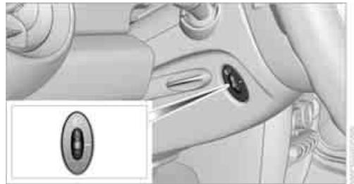
Die Leuchtweite des Abblendlichts muss manuell der Fahrzeugbeladung angepasst werden, sonst wird der Gegenverkehr geblendet.
