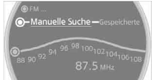
4. MINI Joystick drehen, um eine bestimmte Frequenz einzustellen.
