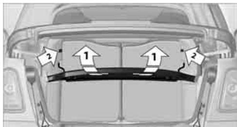
2. Kofferraumabdeckung aus den unteren Aufnahmen nach hinten herausziehen und nach oben schwenken, siehe Pfeile 1,
