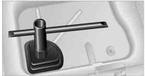
3. Hebegriff aus dem Bordwerkzeug auf das Gewinde schrauben.
