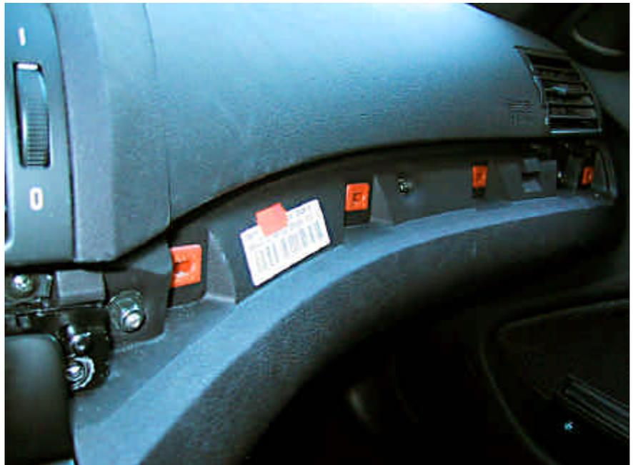
DER 10-POLIGE STECKER WIRD VON HINTEN DURCH DIE AUSSPARUNG GEFÄDELT.
