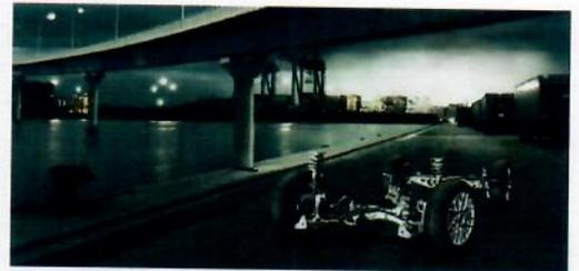
Neben den McPherson-Federbeinen an der Vorderachse und der im Kleinwagen-Segment einzigartigen Zentralenker-Hinterachse ist auch die elektromechanische Lenkung EPS ein Garant für sicheres und begeisternd präzises Handling. Mit der ebenfalls serienmäßig auf der Mittelkonsole platzierten Sporttaste lässt sich eine spürbar dynamischere Kennung mit höheren Lenkmomenten und gesteigerter Präzision aktivieren.
