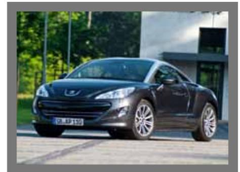
Der schmucke Franzose wird bei Magna Steyr in Österreich gebaut und überzeugt mit verblüffend guter Verarbeitungsqualität. Sein 1,6-Liter-Motor mit Twin-Scroll-Turbo mit 147 kW (200 PS) kommt in ähnlicher Form auch im MINI John Cooper Works (155 kW/211 PS) zum Einsatz. Das Fahrwerk ist sportlich, aber nicht unkomfortabel abgestimmt. Allein der zu erwartende schwierige Wiederverkauf trübt die ansonsten positive Bilanz.
